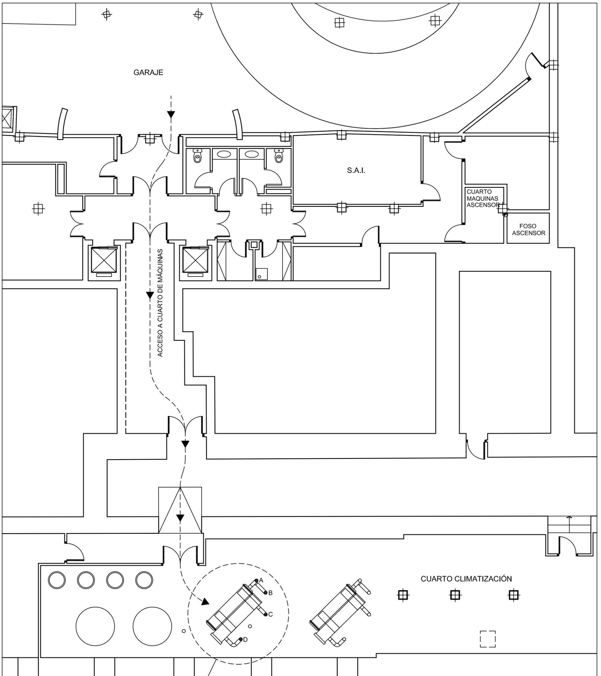
MÁQUINA A SUSTITUIR
