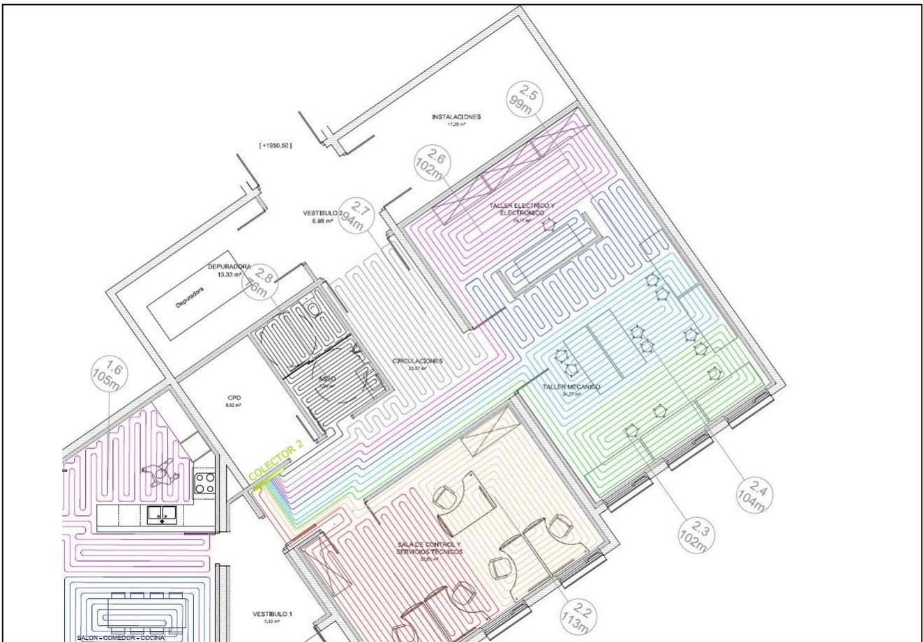
Figura 11. Distribución del suelo radiante por la Sala de AIV
