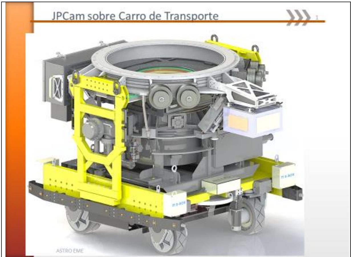
*Figura 5. JPCam sobre Carro de Transporte*
